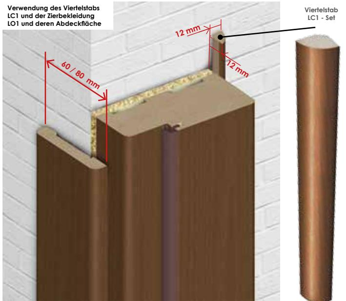
DIE ZIERBEKLEIDUNG (LO1) UND DER VIERTELSTAB (LC1) KÖNNEN FÜR EINE BLOCKZARGE MIT EINER TÜR DER BREITE „60“-„90“ VERWENDET WERDEN. BEI TÜREN DER BREITEN VON „100“ UND „110“ IST EINE ZIERBEKLEIDUNG ODER EIN DOPPELTER VIERTELSTAB (LC2) ZU BESTELLEN.
