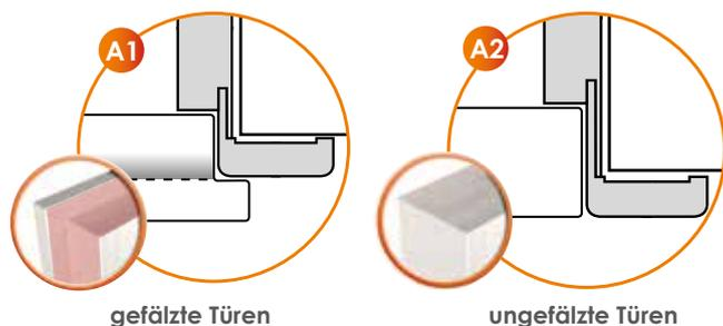
Die Kante einer **gefälzten Tür** ist mit einem Falz (einem Einschnitt - Abb. A1) abgeschlossen, der die Zarge überlappt. Auf diese Weise hergestellte Türen schließen nicht bündig mit der Zarge ab.
